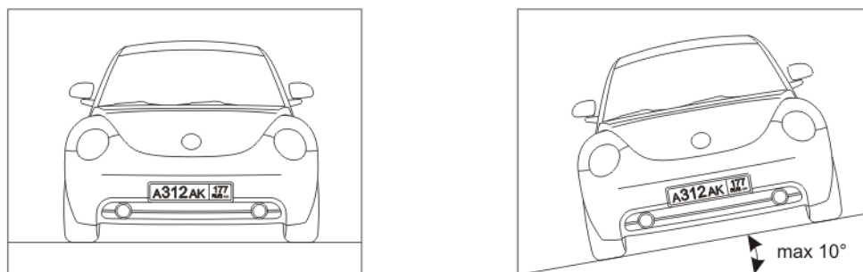
Рис. 5. Изображения с правильно установленной камеры (угол поворота камеры относительно оптической оси не превышает 10^\circ )
